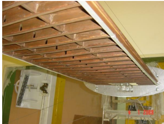
รูปที่ 4. การศึกษาแรงลมและการตอบสนอง ของสะพานวงแหวนอุตสาหกรรม ตั้งอยู่ที่กรุงเทพ โดยอุโมงค์ลม ธรรมศาสตร์-เอไอที
