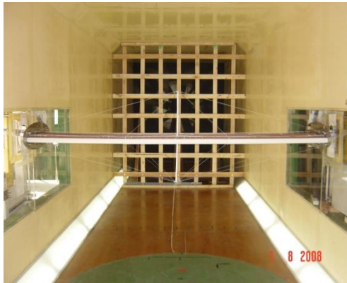
รูปที่ 4. การศึกษาแรงลมและการตอบสนอง ของสะพานวงแหวนอุตสาหกรรม ตั้งอยู่ที่กรุงเทพ โดยอุโมงค์ลม ธรรมศาสตร์-เอไอที
