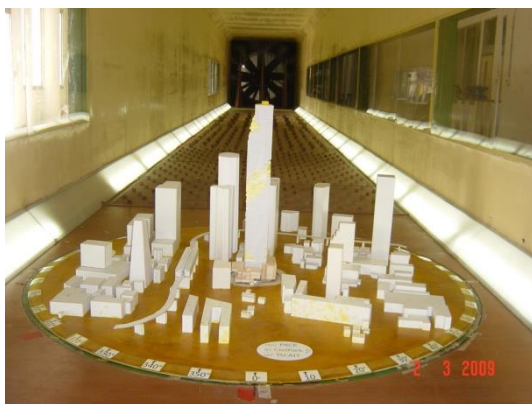
รูปที่ 3. การศึกษาแรงลมโดยรวมและการตอบสนอง ของอาคารมหานคร สูง 310 ม. 75 ชั้น เป็นอาคารที่ สูงที่สุดในประเทศไทย ตั้งอยู่ที่กรุงเทพ โดยอุโมงค์ลม ธรรมศาสตร์-เอไอที
